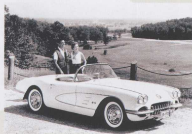
1958年, Corvette首次采用了4颗前照灯设计, 车头新增加了左右2个副进气口, 侧面也增加了新的鱼鳃式装饰。
