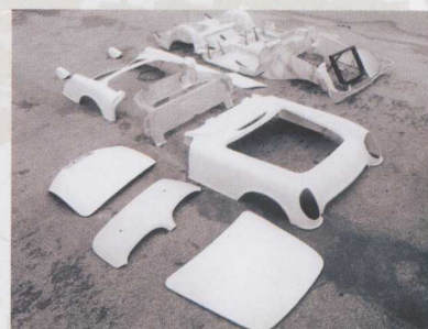
Corvette是第一款采用玻璃纤维制作车身的量产车。这种材料的优势是加工起来非常方便, 能让设计师更易造型。这对于通用花短短半年时间从展示到投入到生产起了决定性作用。
