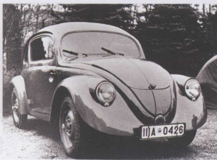
1937 年, 制造了 30 辆 VW30 原型车, 并对这些车辆进行了大规模的路试, 行程达到 2,400,000 km。
