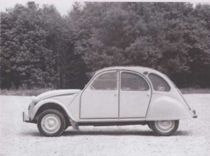
1954年，2 CV进行了首次改进，发动机排量增加到425mL；1956年12月，发布了type AZL版本，拥有更大的、矩形的尾窗和织物发动机罩，这是当时最豪华的2 CV版本。
