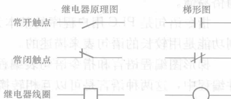
图 1-2 继电器原理图与梯形图符号对照
