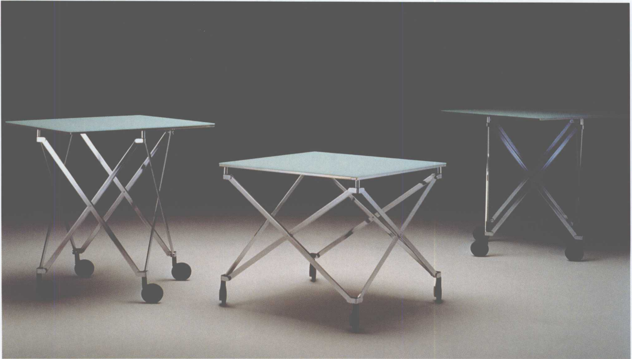
X型结构、桌腿为滚轮的小桌，只要改变与桌面的链接点，就可以实现调整高度的功能。
