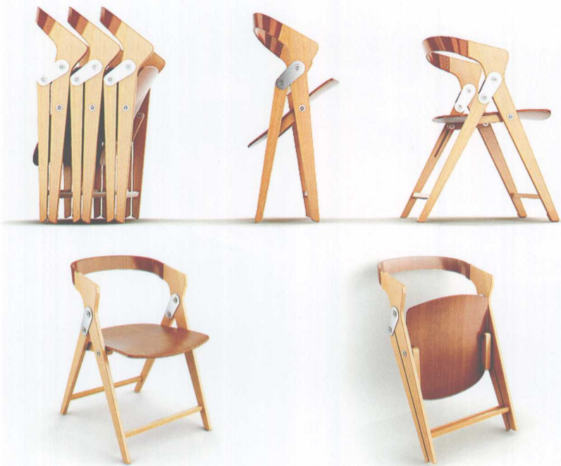
木制折叠椅。基本上保留了经典椅型的构架，靠背的弯曲件用结构件和前腿顶部交错搭接，前后腿和坐面板采用联动支撑结构。
