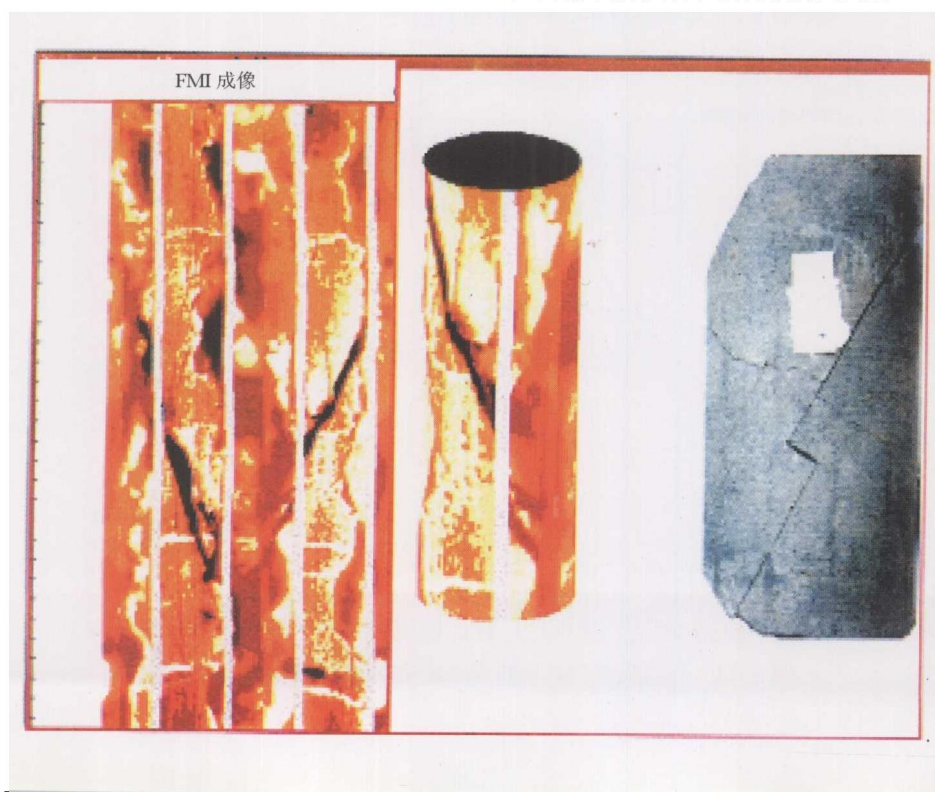
图 3-16 利用成像测井资料识别沉积旋回类型
