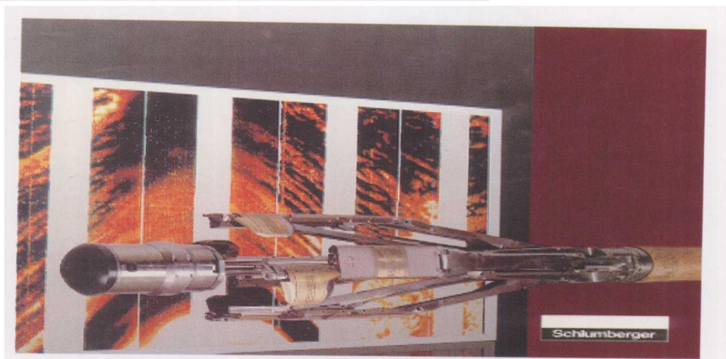
图 3-1 斯伦贝谢 FMI 电成像测井仪器
