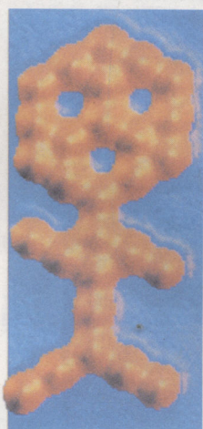
图 11 用原子操纵移位技术将数十个一氧化碳分子排成 5 nm 高的“分子人”
