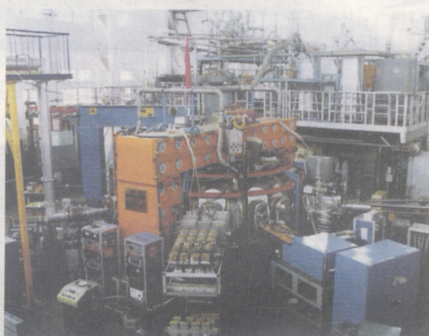
图 12 中国科学院等离子体物理研究所用于研究可控核聚变反应的 HT-7 超导托卡马克装置
