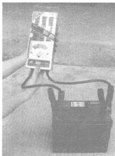
图 1—6 高率放电计测量蓄电池电压
