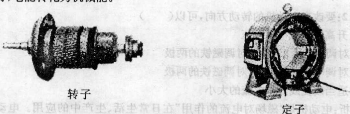
图 15-1-1 直流电动机的构造
