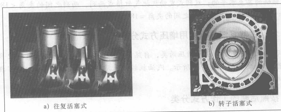
图 1-14 不同工作方式活塞发动机
