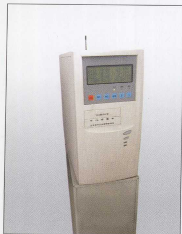
多参数水质监测仪监测补水断面水质信息
