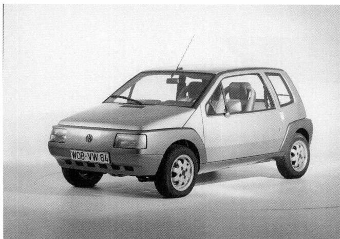
27. 大众汽车 1983 年的概念车“Student”，由于极其坚固的结构，它的高行驶效率和它的低消耗要先于它的时代十几年。但我们当时的成本情况妨碍了生产这种在生产技术上也富有创意的汽车。
