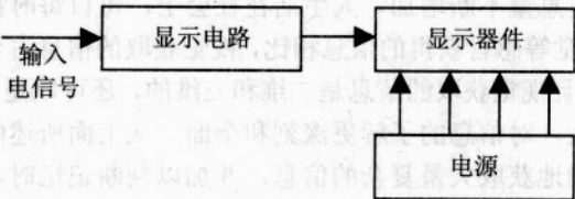
图 1-2 显示器的基本结构
