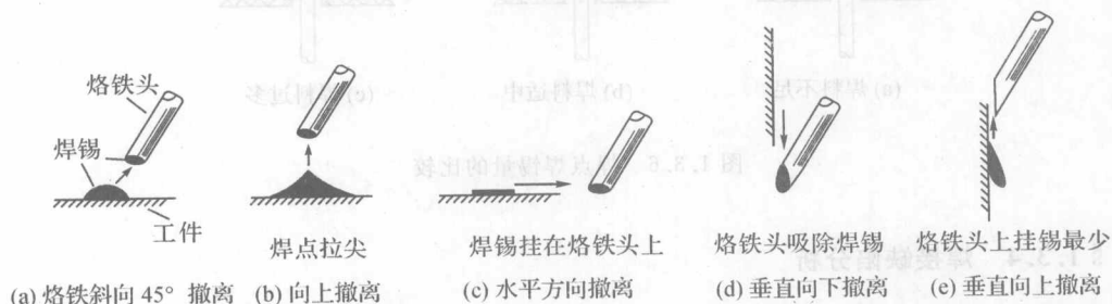
图 1.3.5 烙铁头撤离方向与焊锡量的关系
