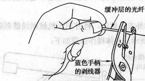
图 1—11 “光纤剥线器”剥除光纤缓冲层
