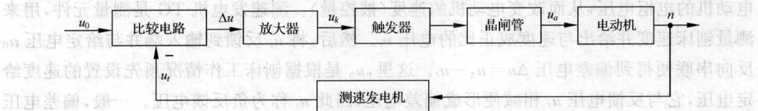
图 1-4 龙门刨床速度控制系统方块图
