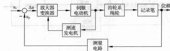
图 1-9 函数记录仪方块图
