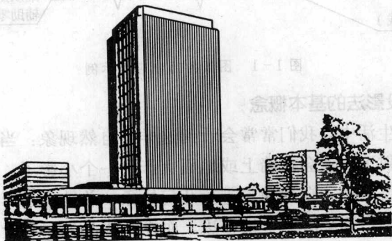
图 1-3 用中心投影法绘制的图样
