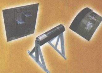
中海油、“西气东输”输送管道对接 环焊缝AUT检测试块
