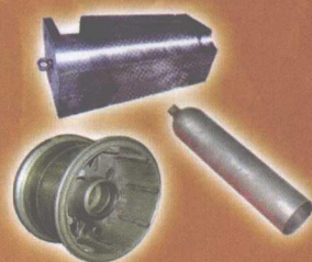
核电站、飞机轮箍、消防桶 超声检测对比试块
