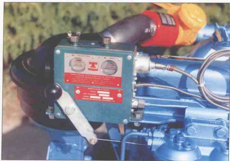
图 2. 泰廷顿控制器公司的“发动机守护者”，安装在汽车发动机上进行保护，不需要电气连接
