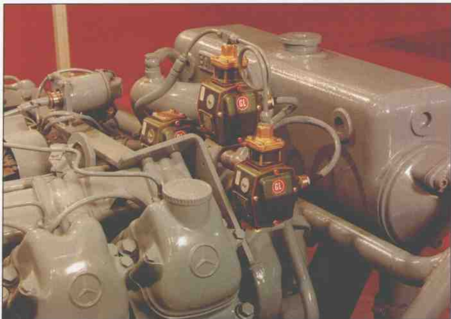
图 1. 在麦而西特工业柴油发动机上用的 3 种大负荷保护设备，用来监测滑油温度、压力以及冷却液的温度
