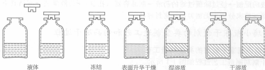
图 1-2 冷冻干燥过程中制品的状态变化
