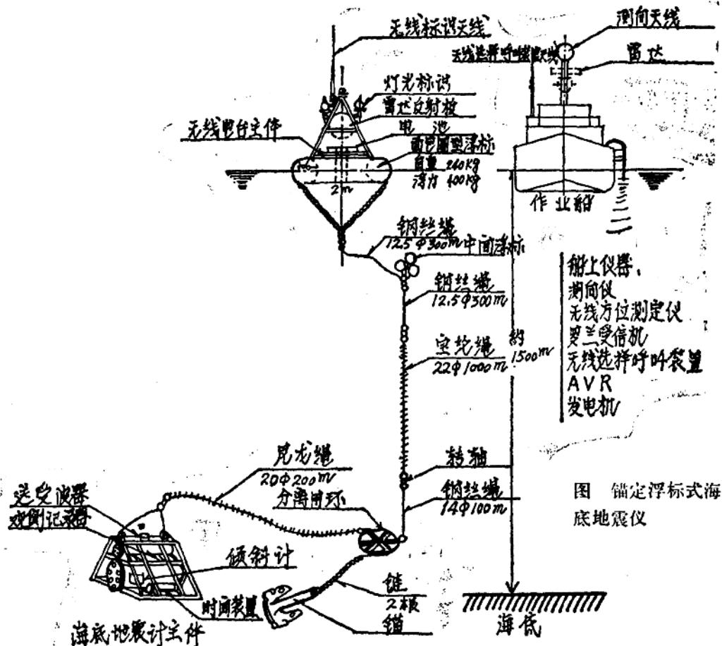
锚定浮标式海底地震仪如图所示，有三部分构成。(1)设置在海底的被称为海底地震仪主体的地震振动记录装置；(2)绳索浮标系统；(3)设在观测船和研究室里的记录再生装置。地震仪的主体包括耐压容器及其拾震器、放大器、记录器、石英钟和电源电池等计测仪器。所用的仪器要求(1)适合观测海底地震；(2)小型化；(3)耗电量少；(4)完全自动记录；(5)能长期记录等。
