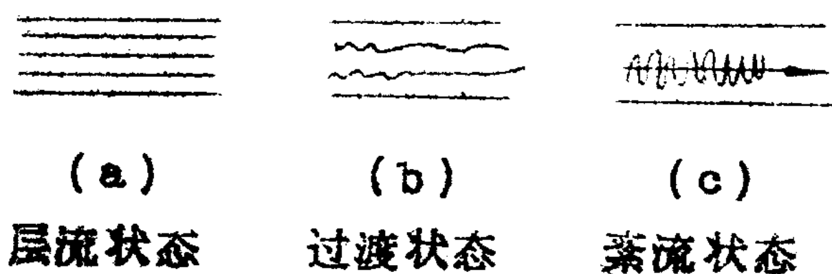
图 2 - 2 A B 管中水的几种流动状态
