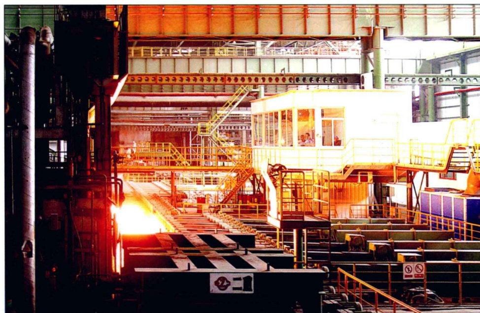
国内第一条具有自主知识产权的国丰1450mm中薄板坯连铸连轧生产线
