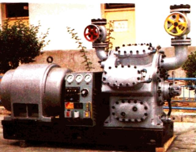
烟台冷冻机厂生产的“烟机”牌制冷压缩机系12.5系列活塞式氨制冷压缩机，产品荣获机械部优质产品称号，其中8AS型获国家银质奖章。
