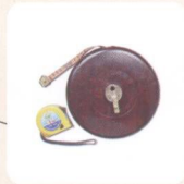
皮卷尺、钢卷尺 用于5米—50米距离测量
