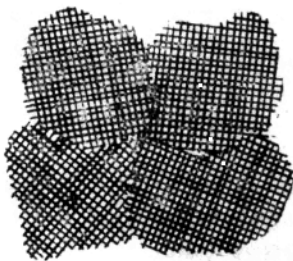
图2—1—8 由不同空间位向晶粒构成的多晶体示意图
