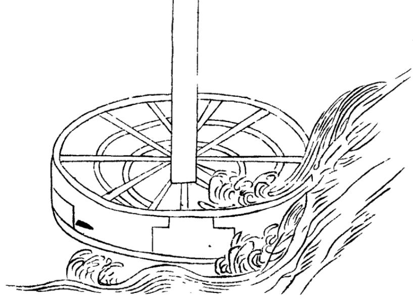
水輪三事謂水轉輪軸可兼三事磨礱碾也初則置立水磨變麥作麪一如常法復于磨之外周造碾圓槽如欲穀米惟就水輪軸首易磨置礱既得糲米則去礱置碾礱軸循槽碾之乃成熟米夫一機三事始終俱備變而能通兼而不乏省而有要誠便民之活法造物之潛機今創此制幸識者述焉詩云制磨元憑一水輪就加礱碾巧相因軸端更平聲置皆從省穀物兼成豈憚頻餅食已供無匱乏米珠重造得圓匀濟民有要無人識農譜圖中擬細陳
