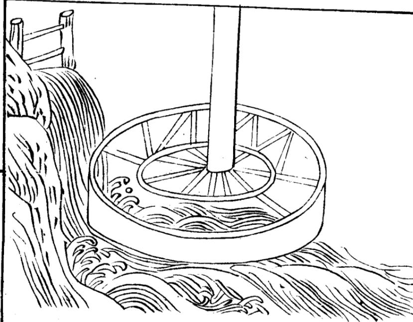
水磨礪同凡欲置此磨必當選擇用水地所先儘並切蒲岸僻水激輪或別引溝渠掘地棧木棧上置磨以軸轉磨中下徹棧底就作臥輪以水激之磨隨輪轉比之陸磨功力數倍此臥輪磨也又有引水置閘甃爲峻槽槽上兩傍植木作架以承水激輪軸腰別作豎輪用擊在上臥輪一磨其軸末一輪傍撥周圍木齒一磨既引水注槽激動水輪則上傍二磨隨輪俱轉此水機巧異又勝獨磨此立輪連二磨也復有兩船相傍切蒲浪上立四檻以茆竹爲屋各置一磨用索繩于急水中流船頭仍斜挿板木湊水拋以鐵爪使不橫斜水激立輪其輪軸通長旁撥二磨或遇泛漲則遷之近岸可許移借比之他所又爲活法磨也庶興利者度而用之詩云用水良有法假物役機智夫禮固利民復以水爲利湍流激輪轉坤軸發樞祕星墜化石圓風旋疑鬼掣動靜法陽陰造化出精粹造化動靜間乾坤具茲器人唯盜物巧越古入極致今看益世功機事詎同視
