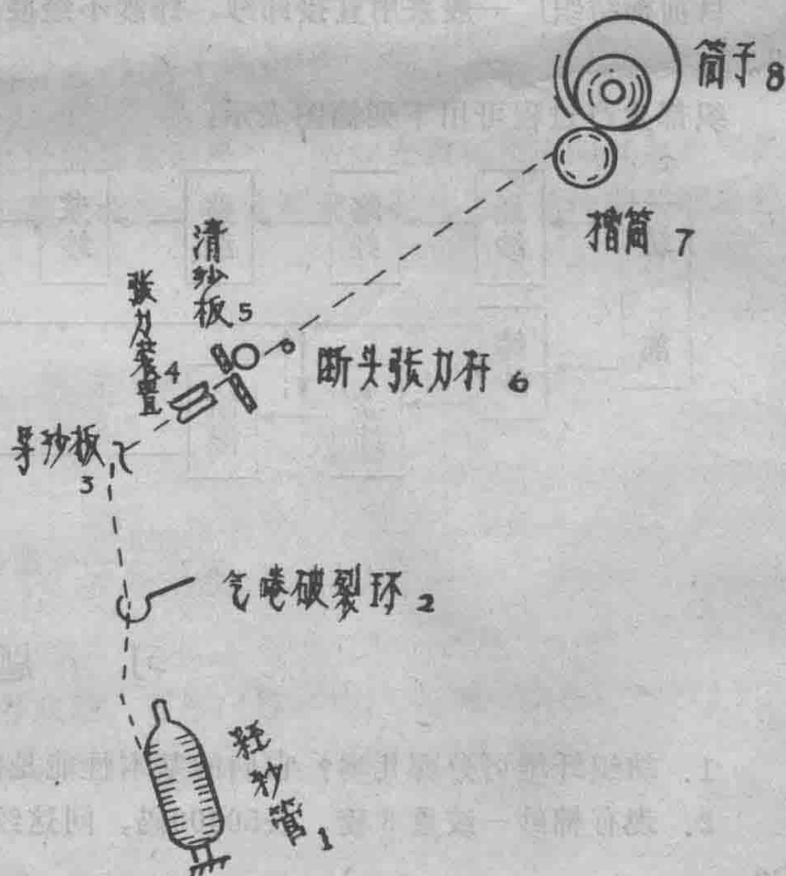
图一1 1332型槽角式络经机生产过程简图
