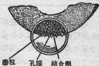
圖 1 砂輪的每顆磨粒就像一把小刀子。
