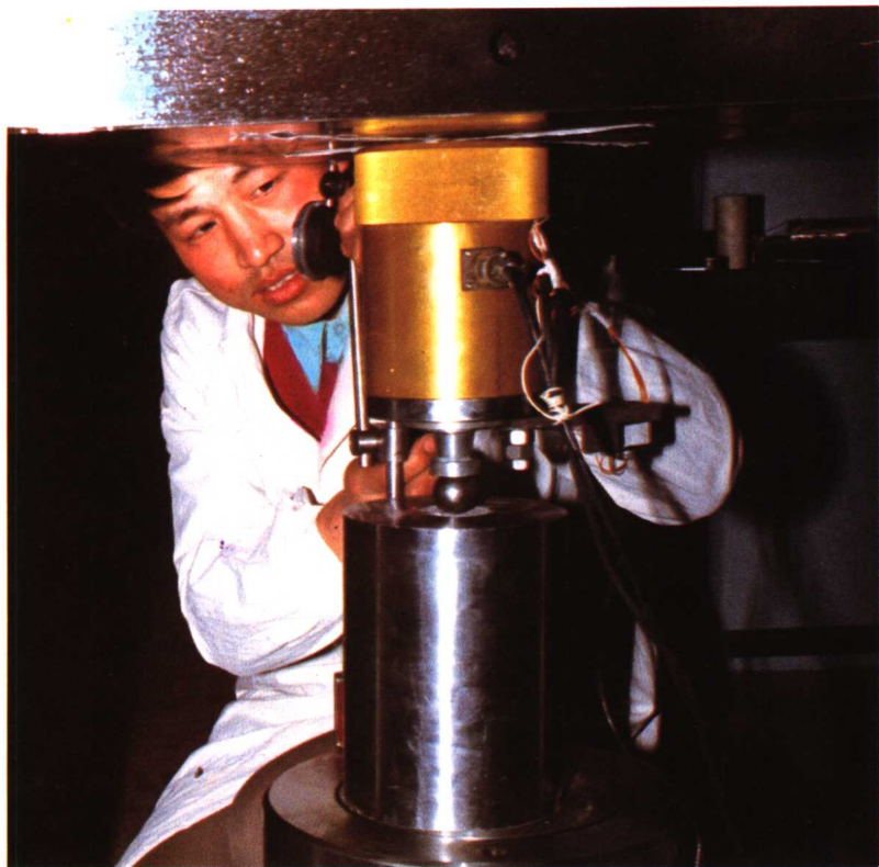
112 带有孔隙水压的4000巴超高压岩石三轴试验装置
