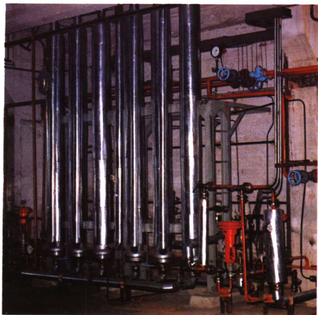
118 80年代初研制成功的氮氢膜分离器已在工业装置上使用
