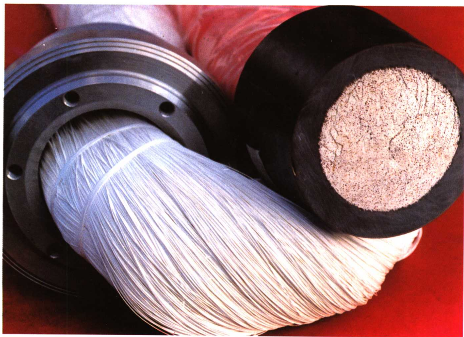
119 氮氢膜分离器中的中空纤维及封头
