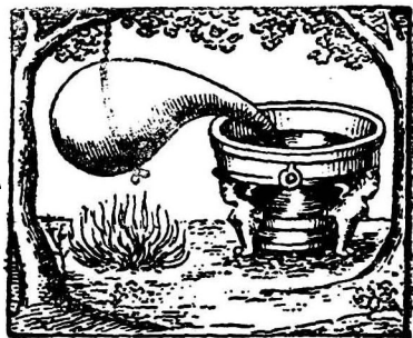
圖二〇八 德勒柏爾之實驗。 表示空氣受熱而生之膨脹
