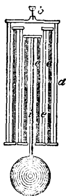
圖二一五 補償擺。 c 為銅棒，b, d, e 及 f 為鐵棒。 銅之膨脹係數，約為鐵之 二倍以上，故若配合適宜， 可使擺之全長一定不變。
