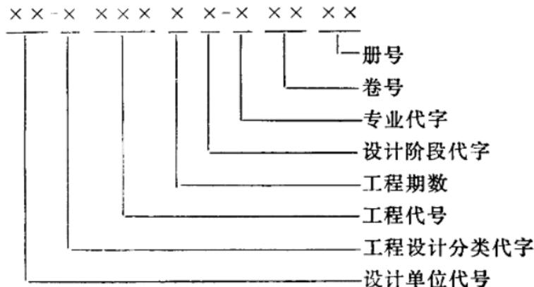
例如：华东电力设计院编制的谏壁电厂四期工程，工程代号308（假定），施工图设计阶段，热机专业，第5卷，第1册，第2号图，则
