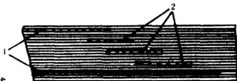
图 1.7 改善电容屏边缘处 电场的一种措施
