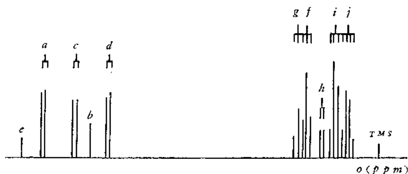
图 8 2-(3-甲基丁基)-5-(甲基)吡啶偏共振去偶 ^{13}\text{C} -NMR 谱图
