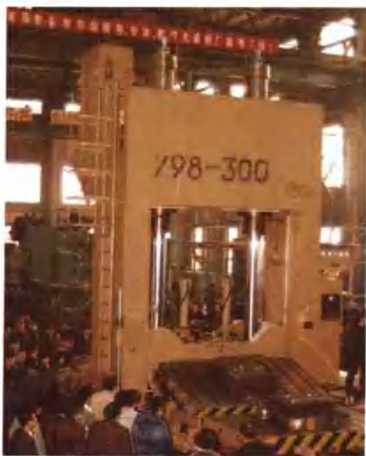
我校与营口锻压机床厂联合研制 通过国家科委主持鉴定的高新技术攻关项目——300T汽车模具研配液压机
