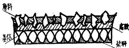
图 1—1 涂附磨具结构示意图
