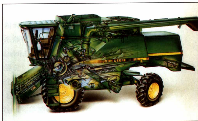
图 1. 滚筒/逐稿器式联合收割机，例如这里展示的约翰·迪尔 9000 系列的联合收割机，是最广泛应用的收割机械
