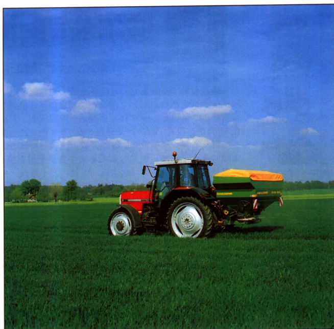
图 3. 依照具体土地的产量潜力而使用肥料的撒播器
