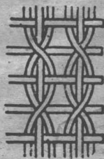
图2 H105 B型捷克无梭噴水織机上所采用的新的布边交織組織
