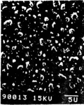
图 1 InSb 薄膜表面形貌图 (放大 1200 倍)
