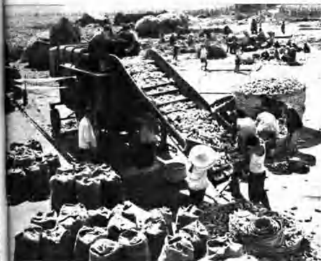
机械操作，提高工效。公社社员正在用脱 粒机进行玉米脱粒。
