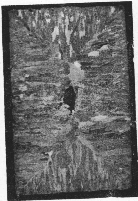
图 I-5 横截面 1:1 盐酸水溶液热蚀
