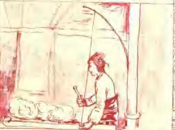
9. 那时,乡亲们弹花还在沿用着一种只有1尺多长的小竹弓,弹力很弱,弹的花也不蓬松。黄道婆改用一种4尺多长的大弹竹弓,用绳作弦,还用弹性代替手敲弦,弹得又匀又蓬松。
