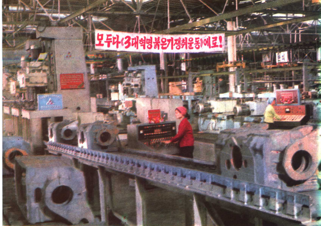
“丰年”牌差速器本体加工自动流水线。
