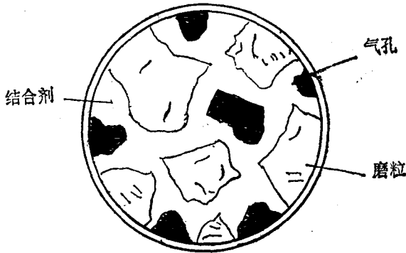
图（2-1）磨具结构放大示意图
