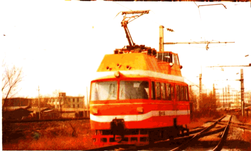
JC-1型接触网 检测车
