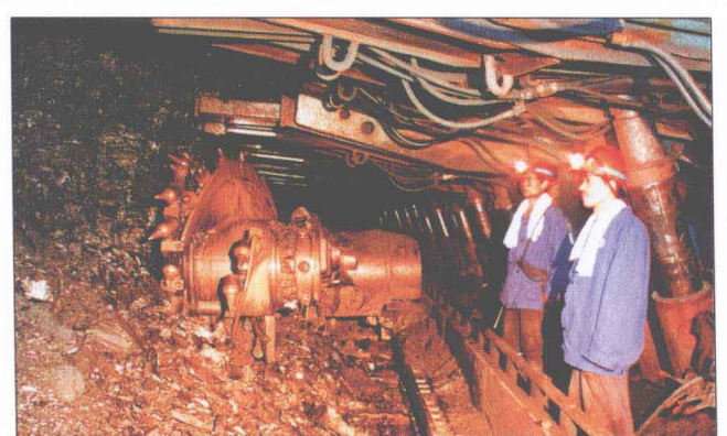
陈四楼煤矿综采工作面
