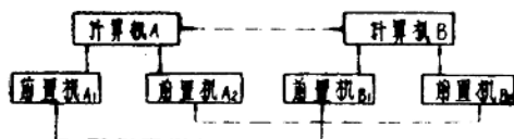
图2 带有多台前置处理机的双机布置图
