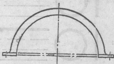
圖 1-5 用假想線表示為防止鑄製變形而加鑄的部份。
