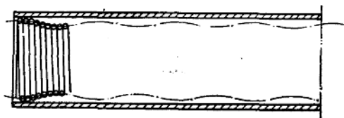
图1—14 送料管的波形弹簧
