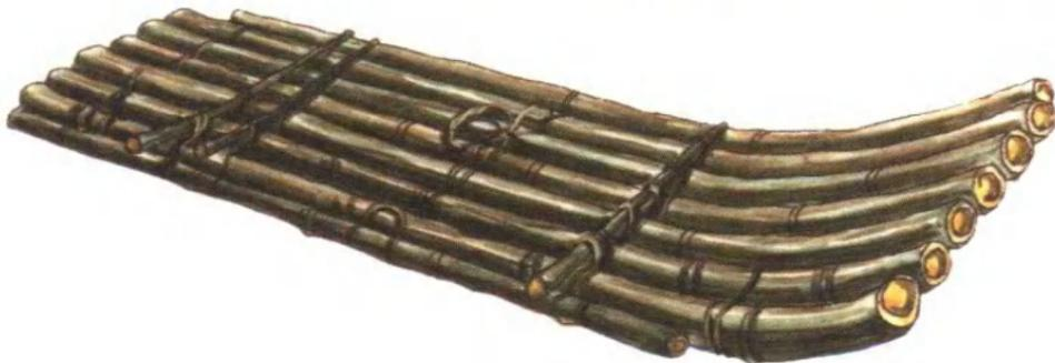
一种用多根竹子捆扎在一起组成的水上运输工具，用于货运和载人。
