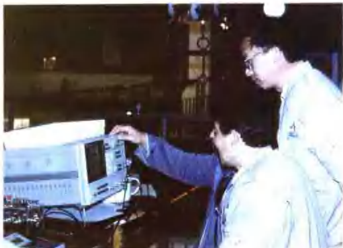
19 调试人员使用本特利测振仪对汽轮机振动进行监测
