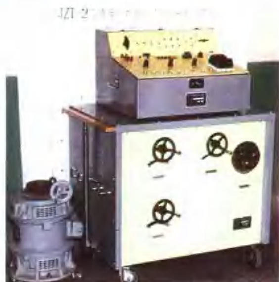
23 电测室研制的继电保护综合试验箱，获西南电业管理局科技成果三等奖。
