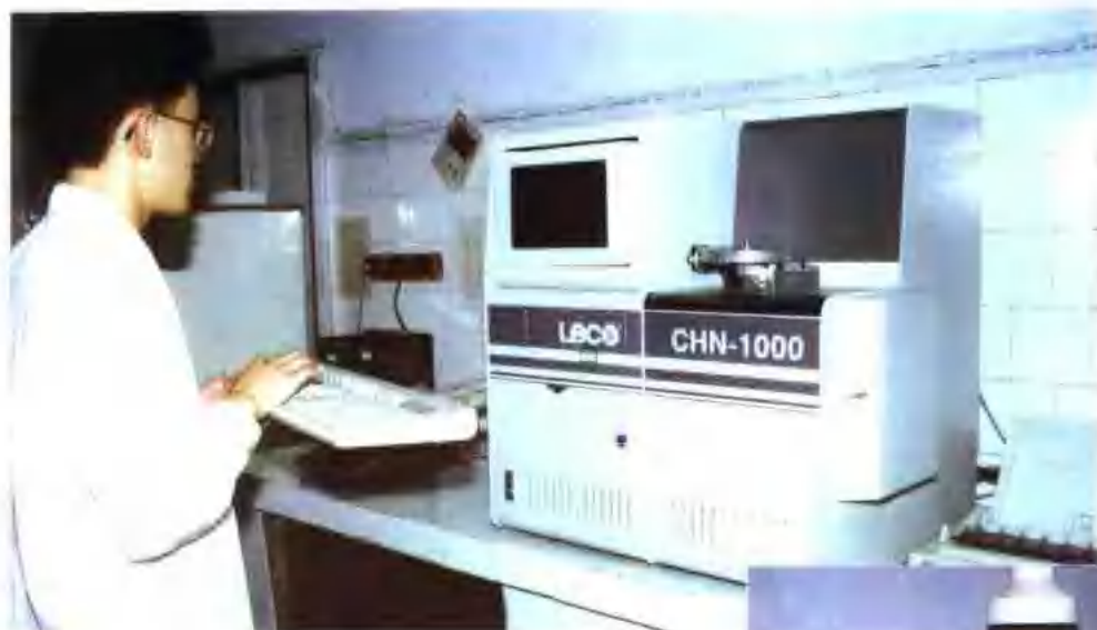
利用 CHN-1000 型元素分析仪, 进行煤、油、土壤有机物的元素分析。
