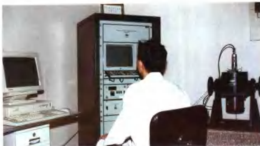
17 从丹麦引进的660型振动传感器校准系统,经国家有关部门考核合格,能够开展振动标准测量设备的检定工作。
