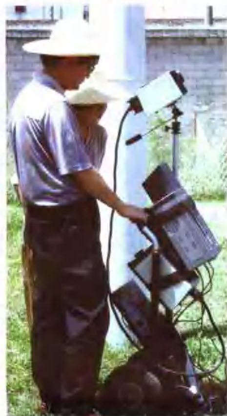
20 应用红外线检测技术,检查设备缺陷。
