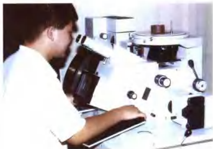
18 用大型卧式金相显微镜进行金相和硬度测试
