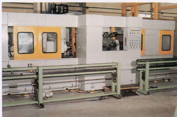
连杆大头孔四工位精镗组合机床
