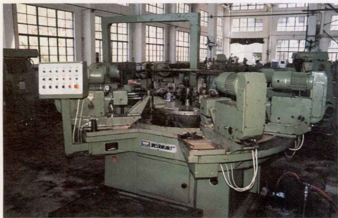
汽车离合器分离杆四工位钻、扩、铰组合机床
