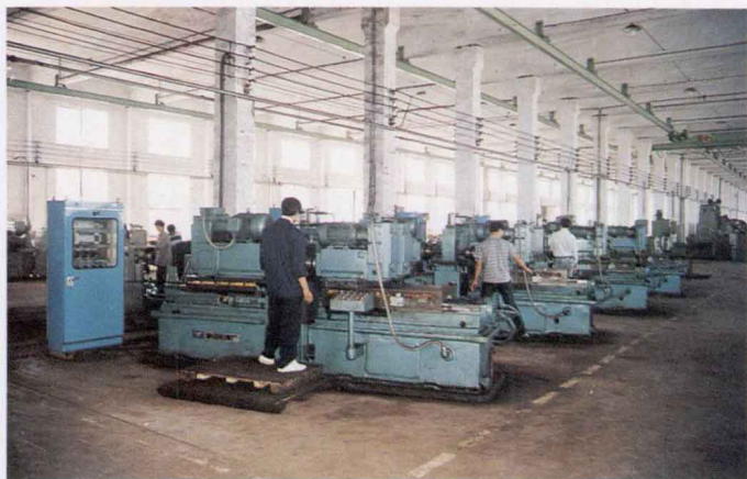
推土机链轨节卧式粗、精组合镗床
