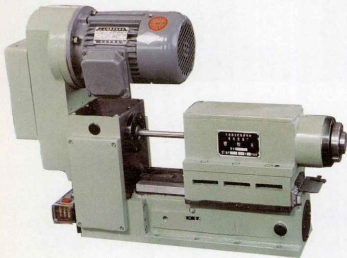
1LXJB 系列箱体移动式机械动力头
