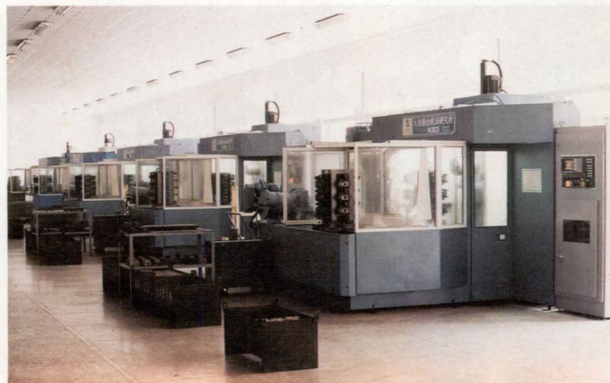
◀ ZHS-K63 卧式加工中心是大连组合机床研究所按英国 FMT 公司 FM100 加工中心技术制造，具有 FMT 公司生产许可证。该机床全面引进其设计、制造、软件和质量保证方面的技术，适用于单机/单元/或联线使用，能满足多品种，不同批量、高效率的加工要求。能满足各种材料大功率高效切削要求。
